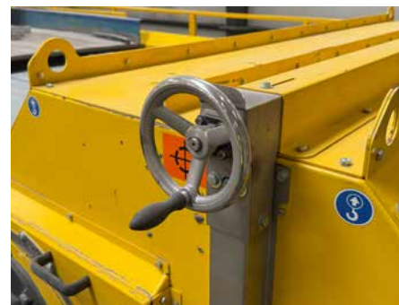
Przegroda, za którą są odrzucane metale nieżelazne ma specjalny profil, który zapewnia odpowiednią sztywność elementu, ale wpływa też na właściwe rozdzielanie frakcji. Jej położenie jest regulowane bezstopniowo przy użyciu niewielkiej korbki.
