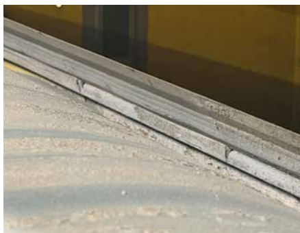
Przegroda, za którą są odrzucane metale nieżelazne ma specjalny profil, który zapewnia odpowiednią sztywność elementu, ale wpływa też na właściwe rozdzielanie frakcji. Jej położenie jest regulowane bezstopniowo przy użyciu niewielkiej korbki.
