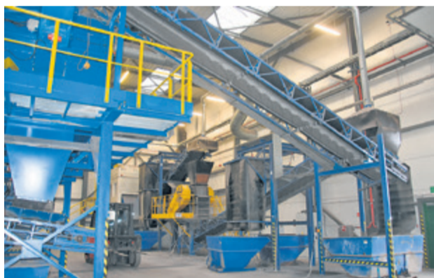
Kabina ręcznej separacji – separator elektromagnetyczny i kruszarka
