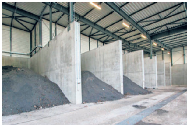
Żużel po odsianiu i frakcjonowaniu przygotowany do odbioru przez uprawnione podmioty zajmujące się ich dalszym zagospodarowaniem
